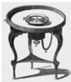
**Fig. 3.** L'apparato di Gudden, microtomo cerebrale costruito da Katsch per von Gudden
